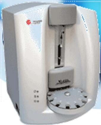
Vi Cell XR為全自動圖像細胞計數儀，使用 Trypan Blue Dye Exclusion，進行精準之細胞計數及活性分析。
